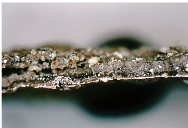
Slike 16. i 17. Fotografije prikazuju uzorke pod mikroskopom, presjek i lice bojenog sloja i maltera: crvena, oker, malter bez lazurnog nanosa, sloj ispod završnog sloja zgrafita .
