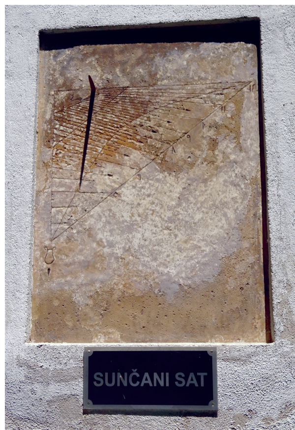
Slika 8. Restaurirana ploča sunčanog sata Hadži Ali-begove džamije snimljena ljetnog solsticija 2023. godine: kraj sjenke pokazuje 5:05 dnevnih alaturka sati (foto. M. Tadić)
