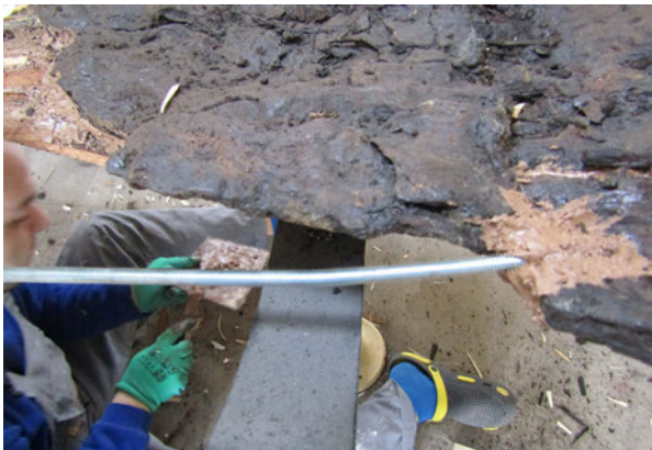
Umetanje metalnih opruga, ojačanja, u prednji dio čamca
